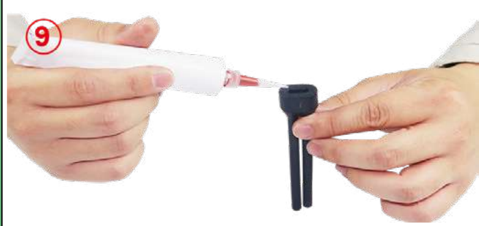
9 : Verser du silicone vulcanisable à la température ambiante dans l'orifice d'entrée du capuchon silicone
